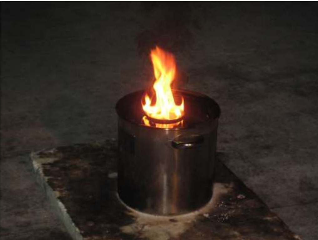
写真5 2回目 120mm 点火源に着火
