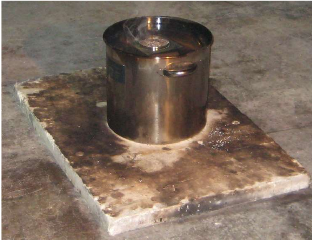
写真 12 60mm 試料油に引火せず、点火源鎮火
