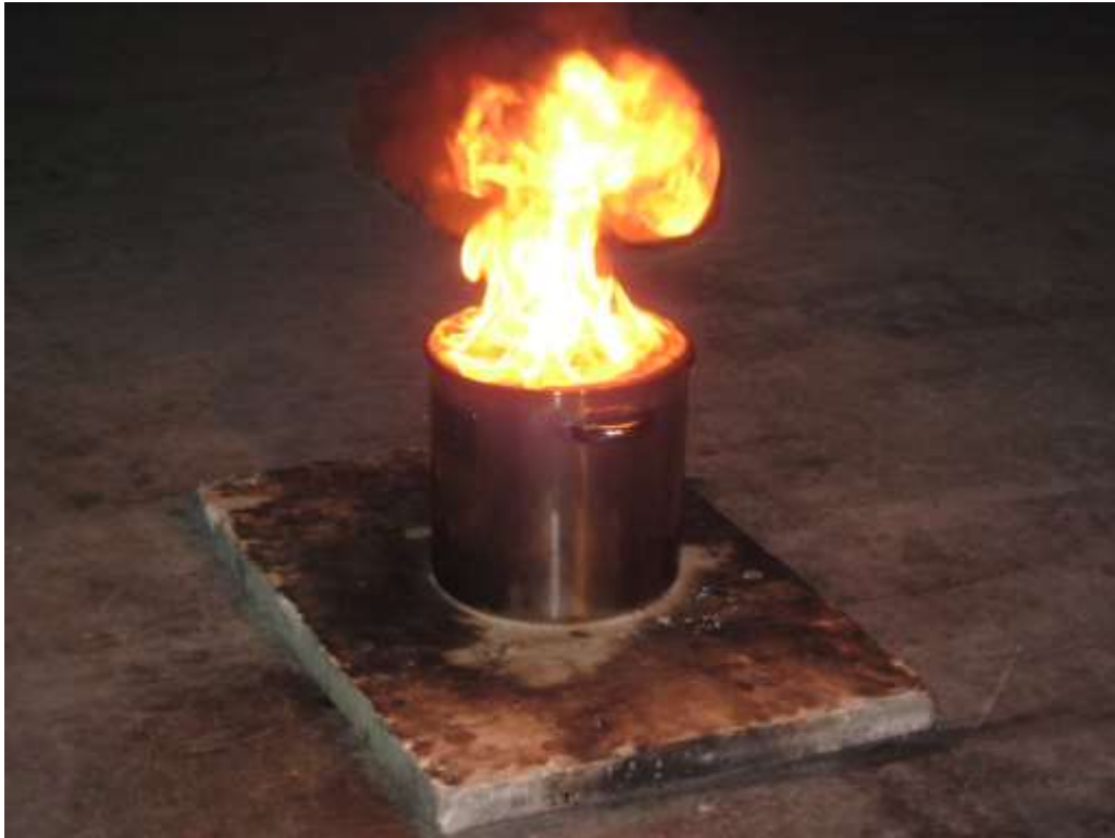
写真6 2回目 120mm 試料油に引火
