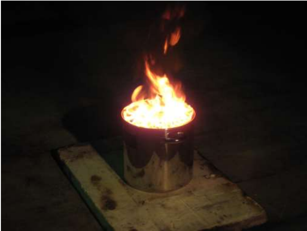
写真3 1回目 120mm 試料油に引火
