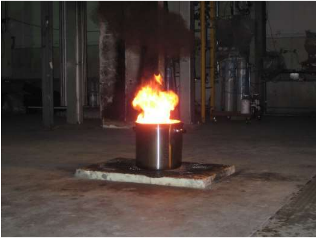
写真9 3回目 120mm 試料油に引火
