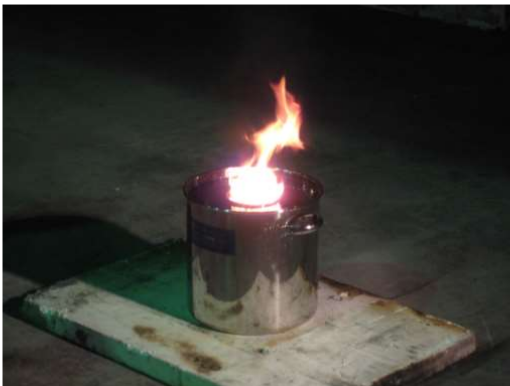
写真2 1回目 120mm 点火源着火
