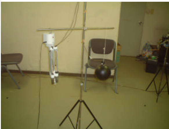
図 2.3.15 アスマン通風乾湿度計と グローブ温度計（日進安静室内）
