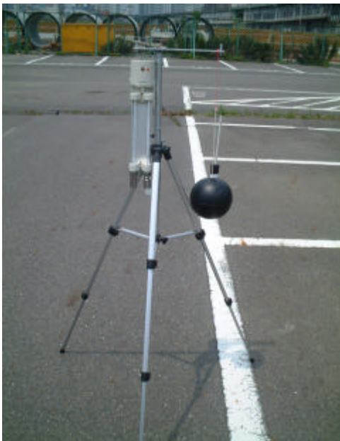
図 2.2.11 アスマン通風乾湿度計とグローブ温度計（ささしま）
