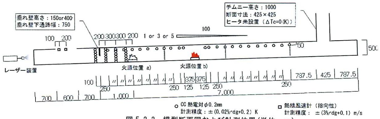
図 5.2.2 模型断面図および計測位置(単位:mm)
