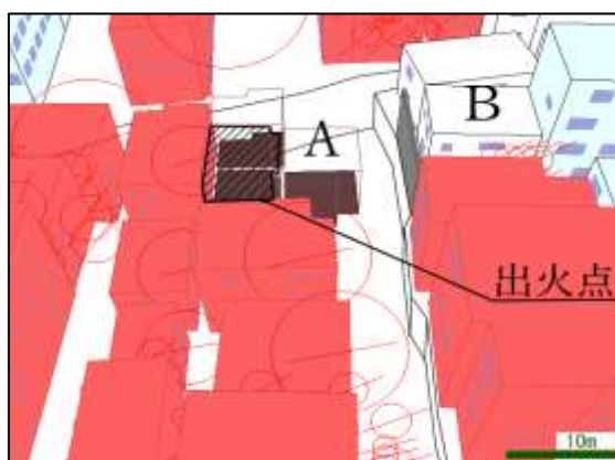
図 4.2-19 塀 3.5m、出火から 72 分後
