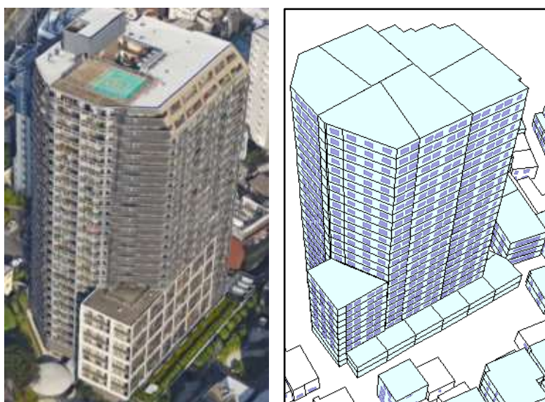
図 3.3-4 実際の建物とシミュレーションの建物の比較 2
