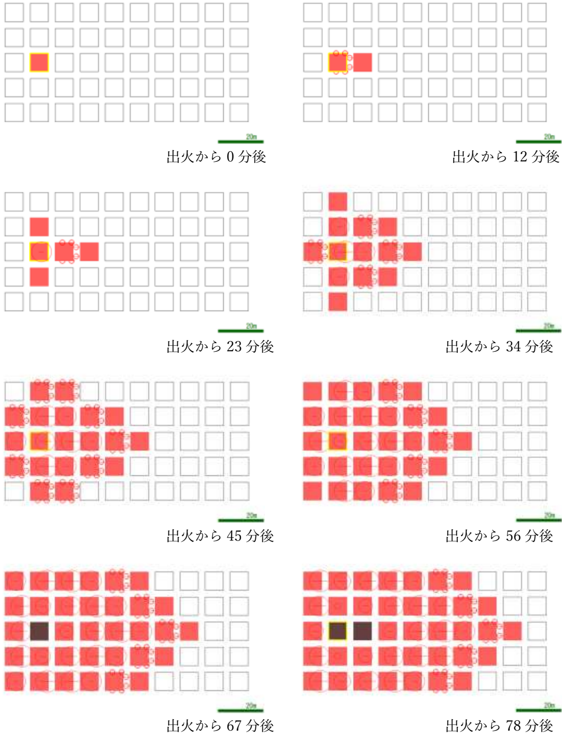
図 3.5-18 防火造 風速 6m/s のシミュレーション結果
