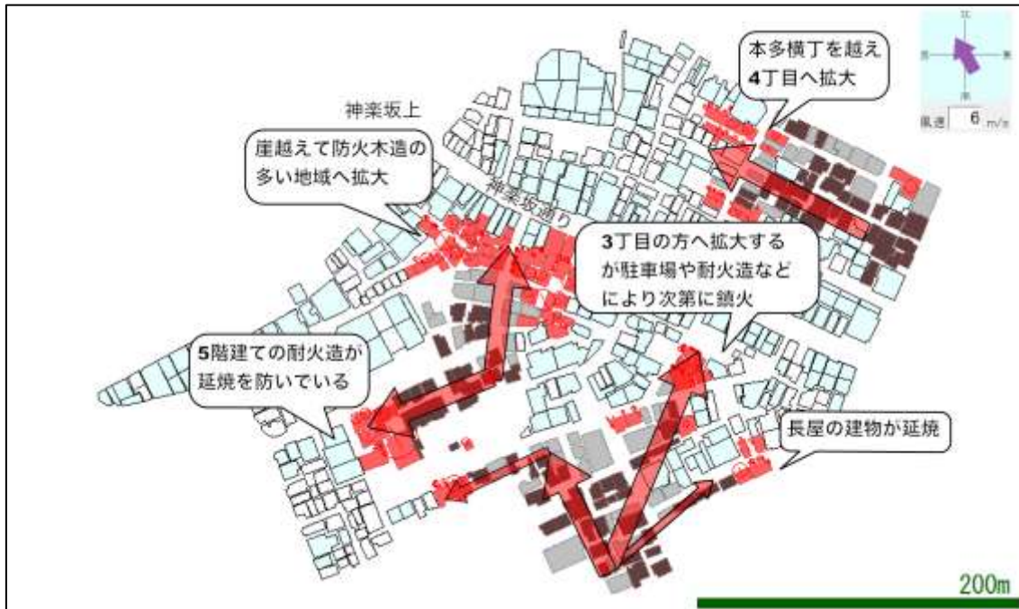
図 4.1-8 出火点からの延焼の様子
