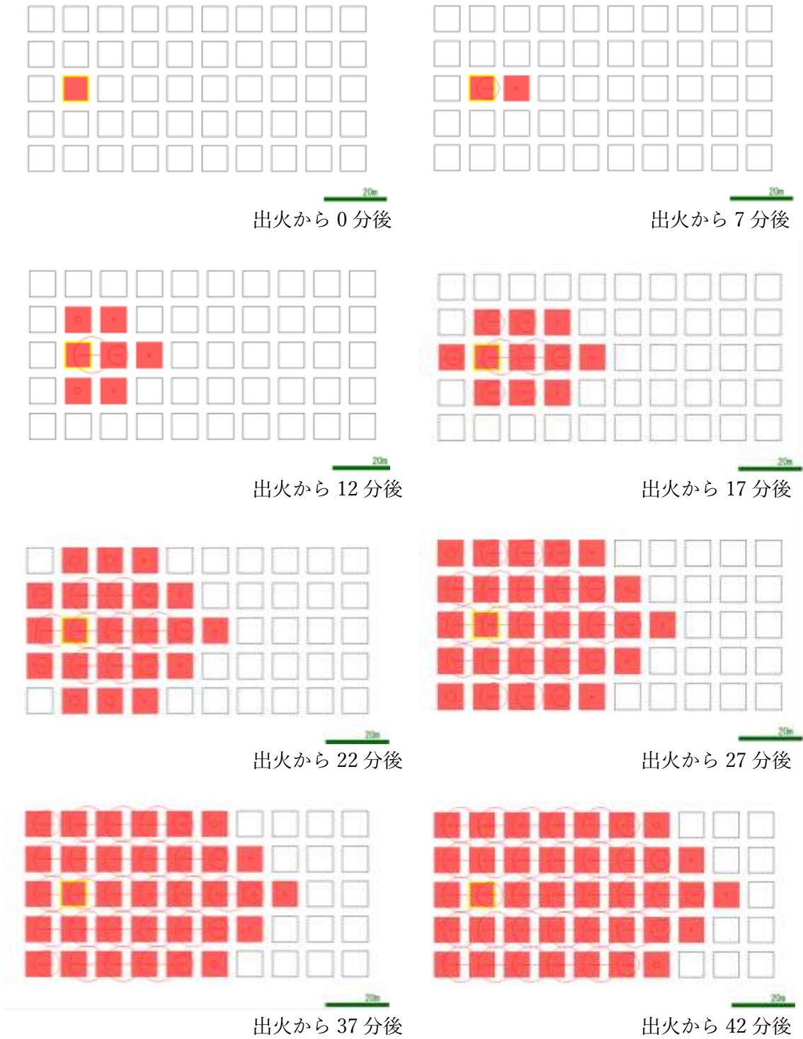
図 3.5-22 裸木造 風速 6m/s のシミュレーション結果
