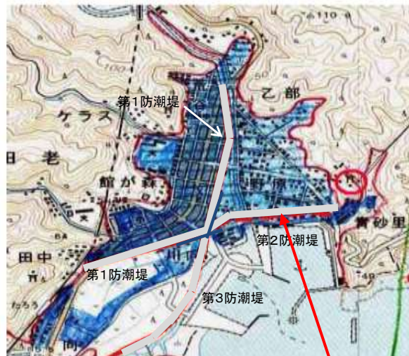
図-4-2 防潮堤崩壊図
