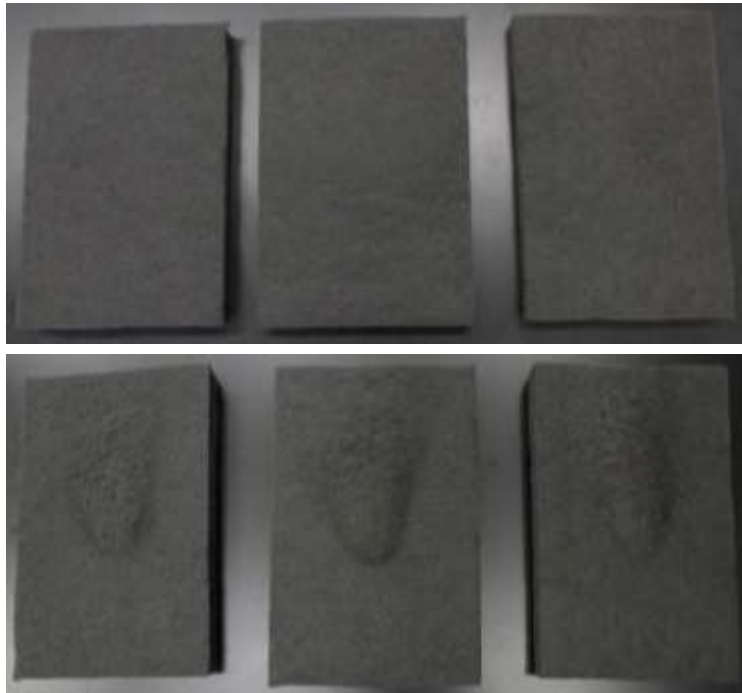
図 3.1.1.13 45° 法試験 断熱材 A 試験前および試験後の試験体
