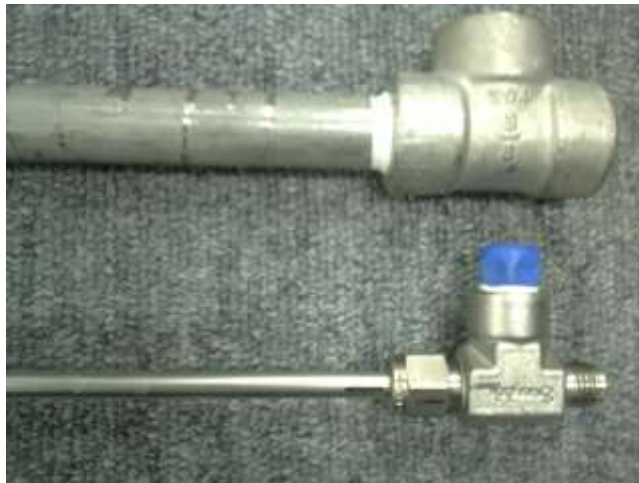
< 図 6 . 既存の配管と Swagelok 社製配管との比較 >
