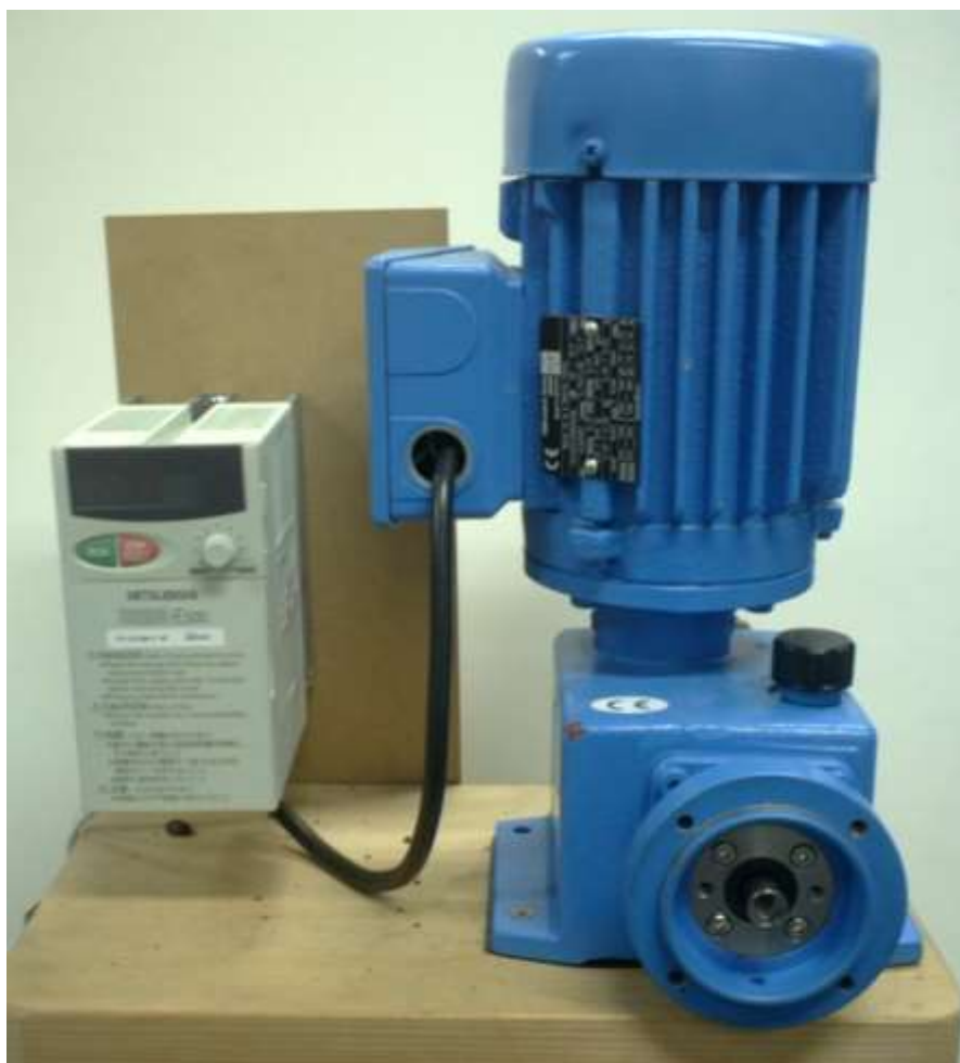
<図 2. 2006 年 10 月に試験を行った Sera 社製高圧ポンプ> 第 10 章まとめ
