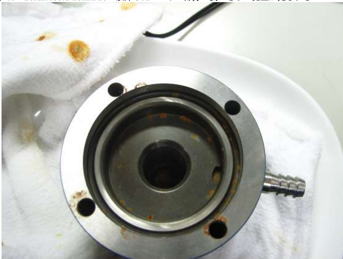
図 41 : SeraR409.1-26K.1/20 ポンプボディの発錆状況 24 時間湿潤試験後。孔食様の
