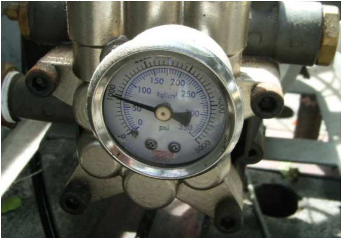
図 6 : 図 2,3,4 のミスト噴霧装置運転時の圧力。約 65\text{kg/cm}^2 (約 6.4\text{MPa} ) と読める。
