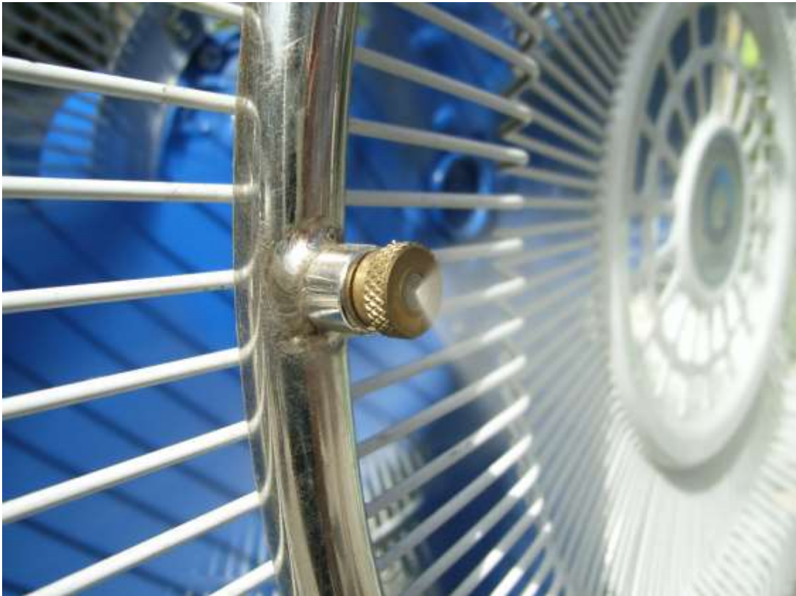
図 4：図 2,3 のミスト噴霧装置に使われているノズル。真鍮製と思われる。噴角が広い。
