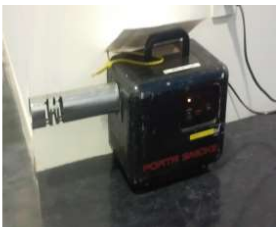
図-54：煙発生装置（右）と、区画したブルーシート（左）
