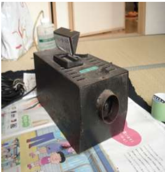
図-48：実験で使った煙発生装置（ロスコ）
