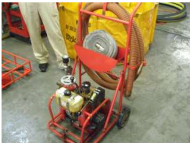
図 3-2 使用可搬ポンプ
