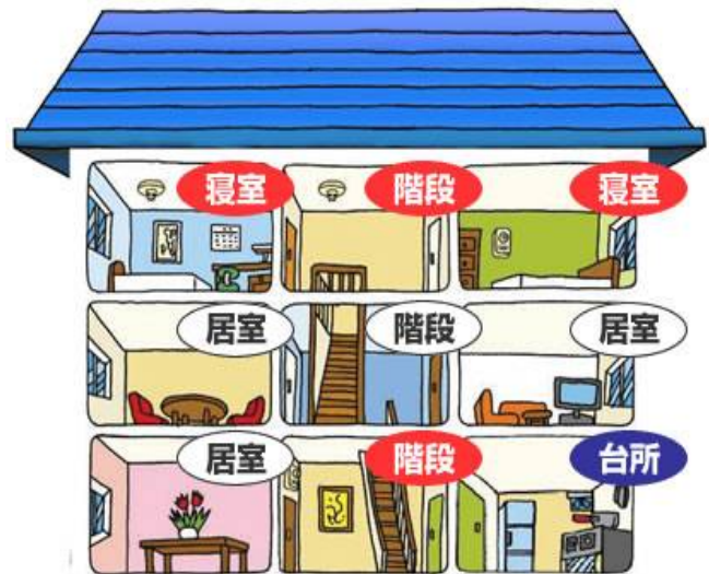
▲図5 住警器の設置箇所タイプA
